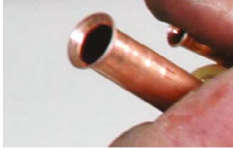
Figure 6.20 Flare the end of the tube (D)
